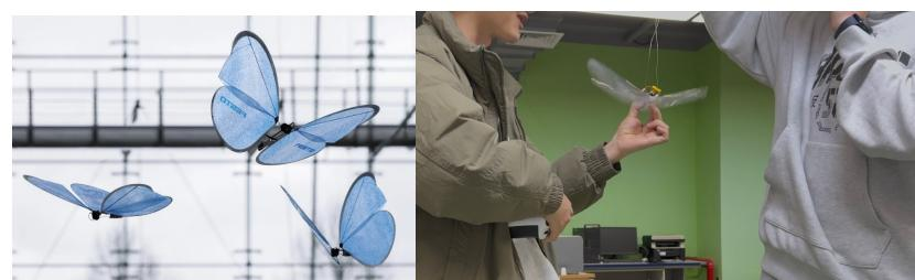
采用碳纤维骨架与 OPP 膜，首创类三角桁架加固工艺，解决翼面纵向失稳。集成双舵机直驱机构，可以实现1-4Hz变频扑动及转向等多姿态控制。定位于室内巡检、环境监测及仿生教育领域。
